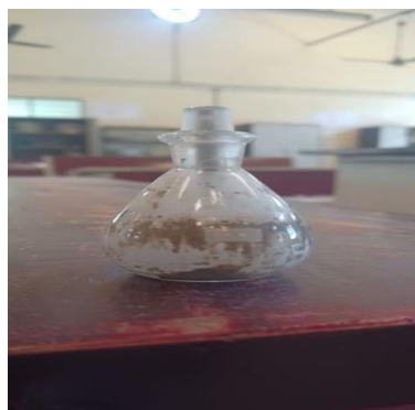
Fig 6.1.1 A Le-Chateliers apparatus
