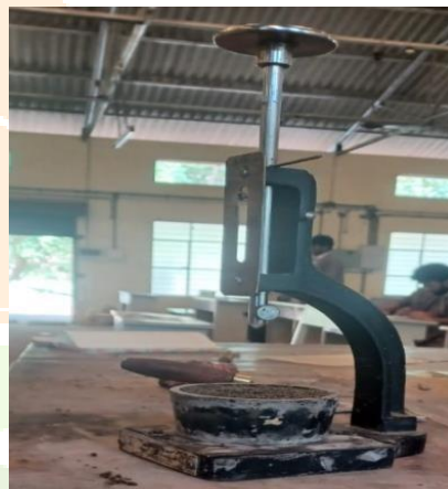
Fig 6.1.2 B: Vicat apparatus
