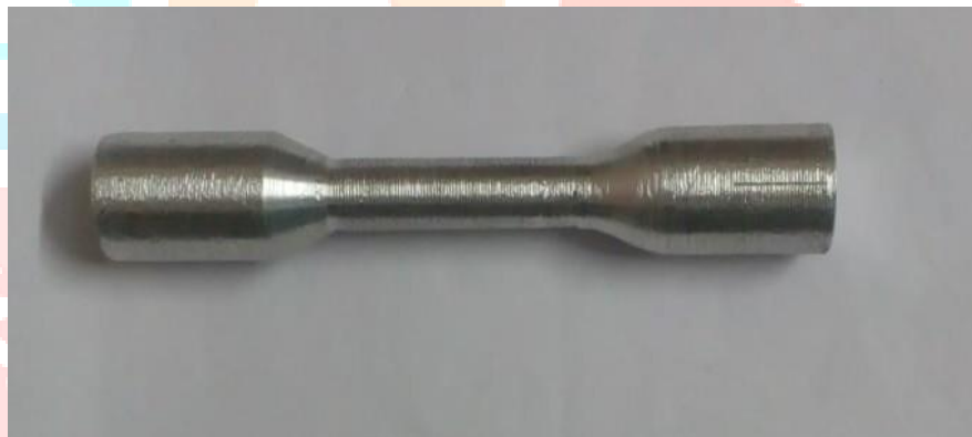
(D) DIMENSIONS OF TENSILE SPECIMEN OF AA7075-SIC
