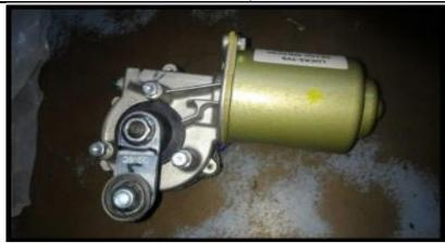
Fig:2 Wiper motor
