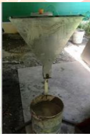
Fig. F. 4 V-funnel Testing
