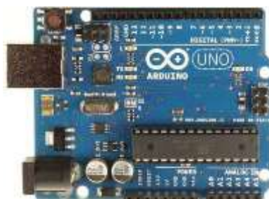
Fig. 3. Arduino UNO Module
