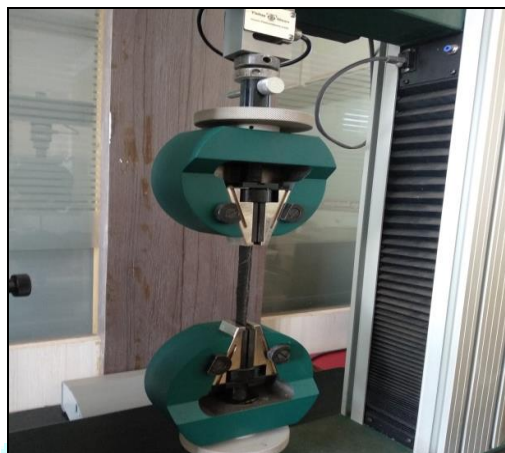
Fig. 5. Tensile test setup
