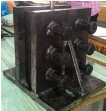
Fig. 1 ECAP total die setup
