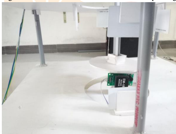
Figure:7 RFID tags and reader arrangement.
