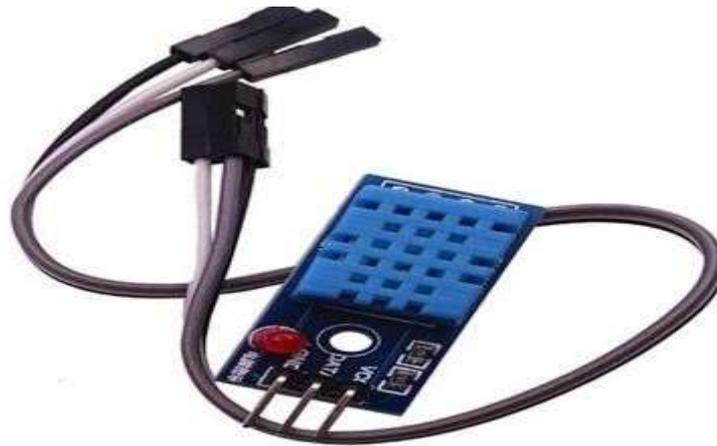
**Fig 3: DHT11 sensor**
