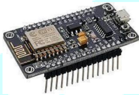
Fig: Node MCU LM2596(DC-
