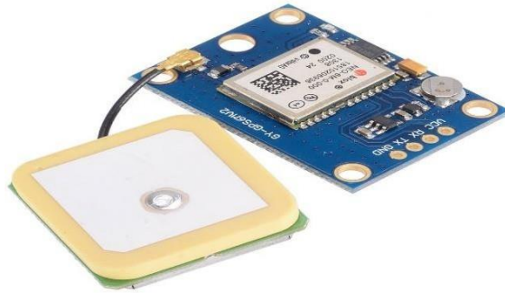
Fig 3.4 GPS(Global Positioning System) Module
