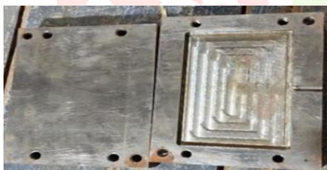
Fig. 2. Die for Plate
