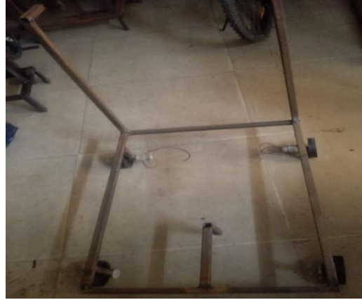
Fig: 7 table welding frame
