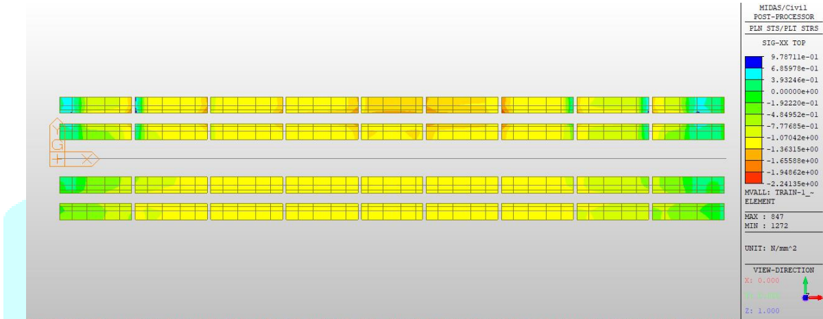
Figure 3a Longitudinal Stress
