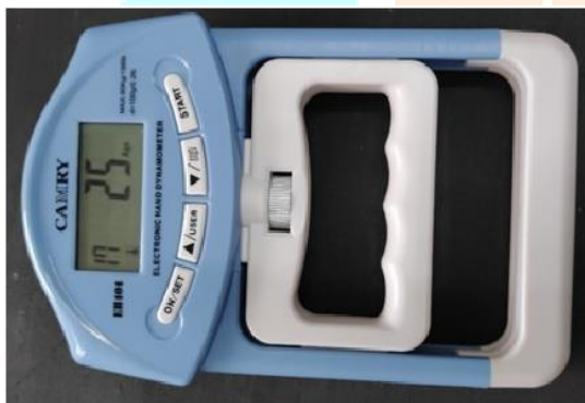
Fig 1 -DIGITAL HAND DYNAMOMETER
