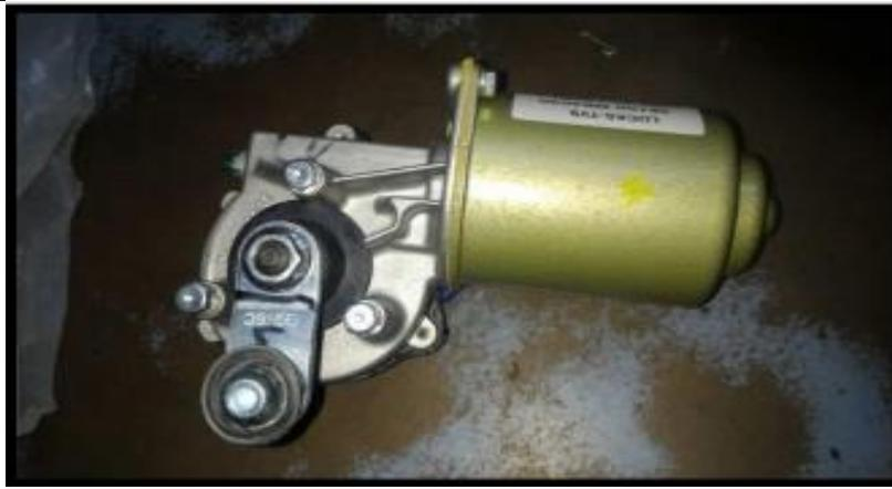
Fig:2 Wiper motor
