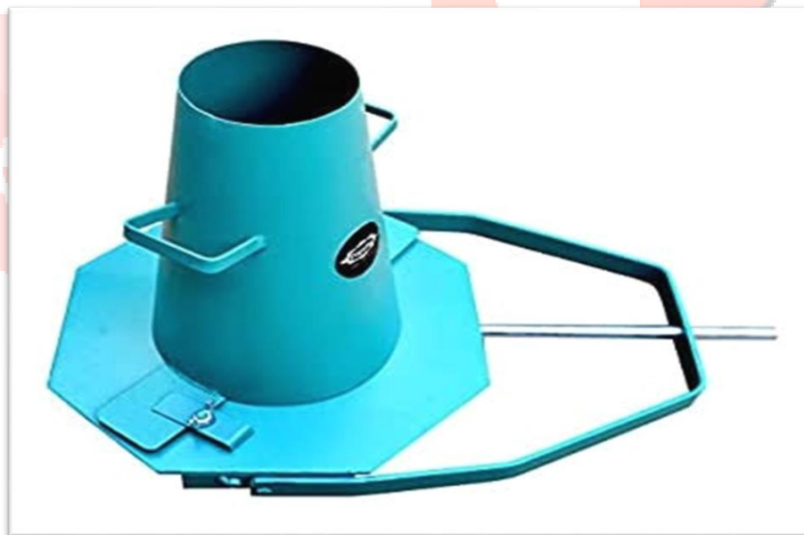
Fig: - Flow Test
