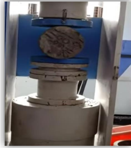
Fig.4 Split Tensile Test
