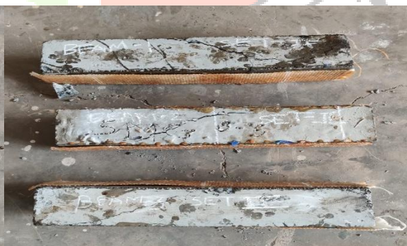
Fig. No : 3 : Crack pattern Set 2
