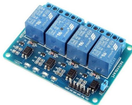
Fig 4(d) Relay module
