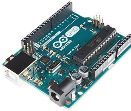
Fig 4(a)- Arduino Uno
