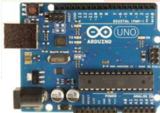
Fig.2 Arduino UNO Micro-Controller
